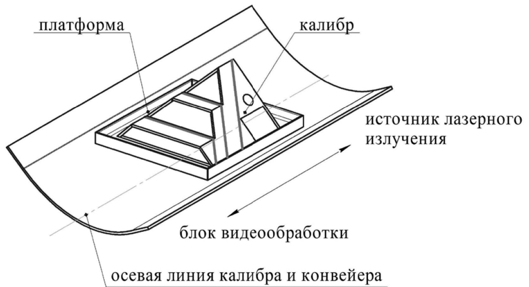
Рисунок 6 – Схема установки площадки и калибра на ленте конвейера
