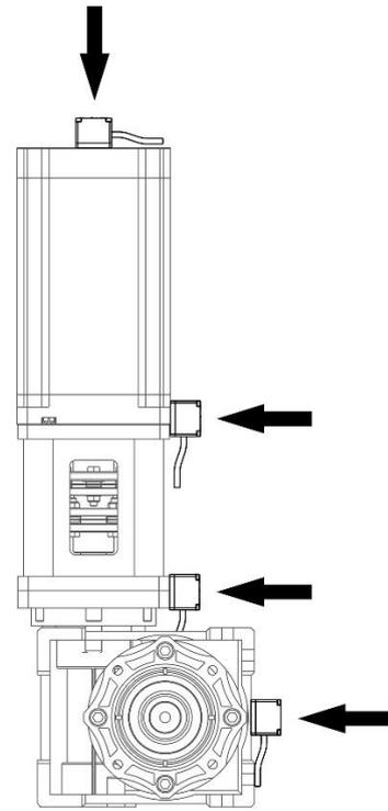
Точки измерения на корпусе подшипника
