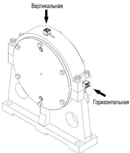
Точки измерения на малых электрических машинах
